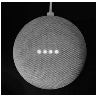
Fig. 1 – Lo smart speaker Google Home Mini non ha nessun elemento grafico e gli unici output che dà sono vocali e luminosi – 23.01.2023
